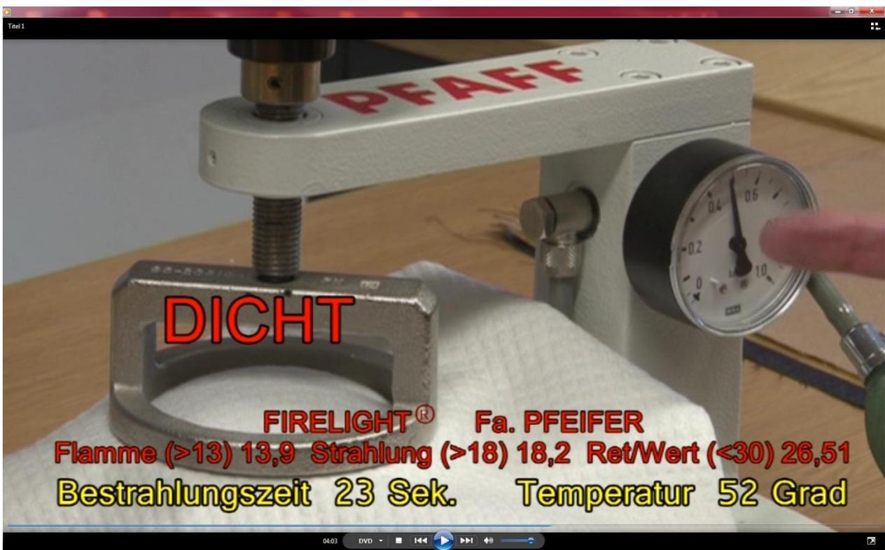
Nach 23 Sek. Bestrahlungszeit und einer Temperatur von 52° auf der Haut ist die Schutzkleidung FIRELIGHT® von Pfeifer **DICHT!!!! Und kann ohne Bedenken für weitere Einsätze als Schutzkleidung verwendet werden!!!!** Da an der Stoffaußenseite keine Schäden zu erkennen sind, ist eine funktionierende Schutzkleidung Vertrauenssache, das wir Ihnen bieten!!!! Qualität von Pfeifer!!! Super Preis mit hoher Sicherheit!!!!
