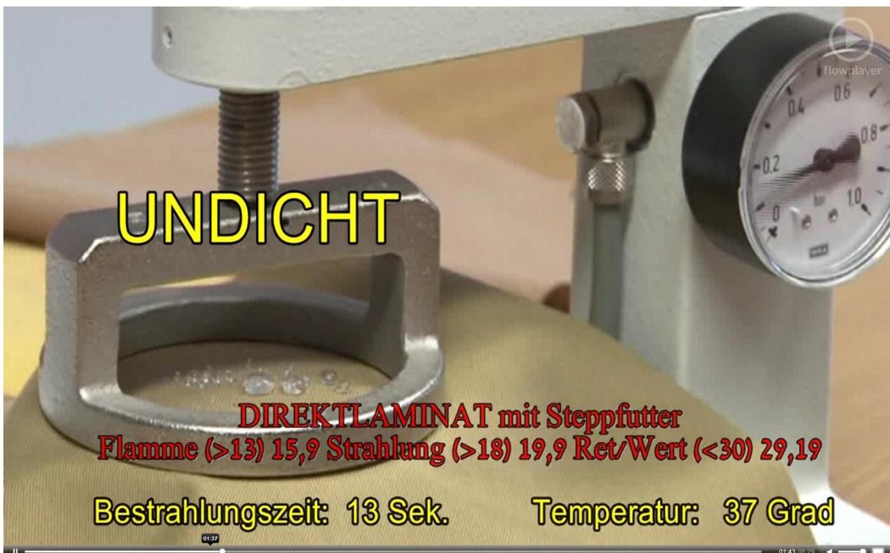
Die Schutzkleidung ist bei einer Bestrahlung von 13 Sek. und bei einer Temperatur von 37° auf der Haut **UNDICHT** und für einen weiteren Einsatz als Schutzkleidung nicht mehr zu verwenden!!!
