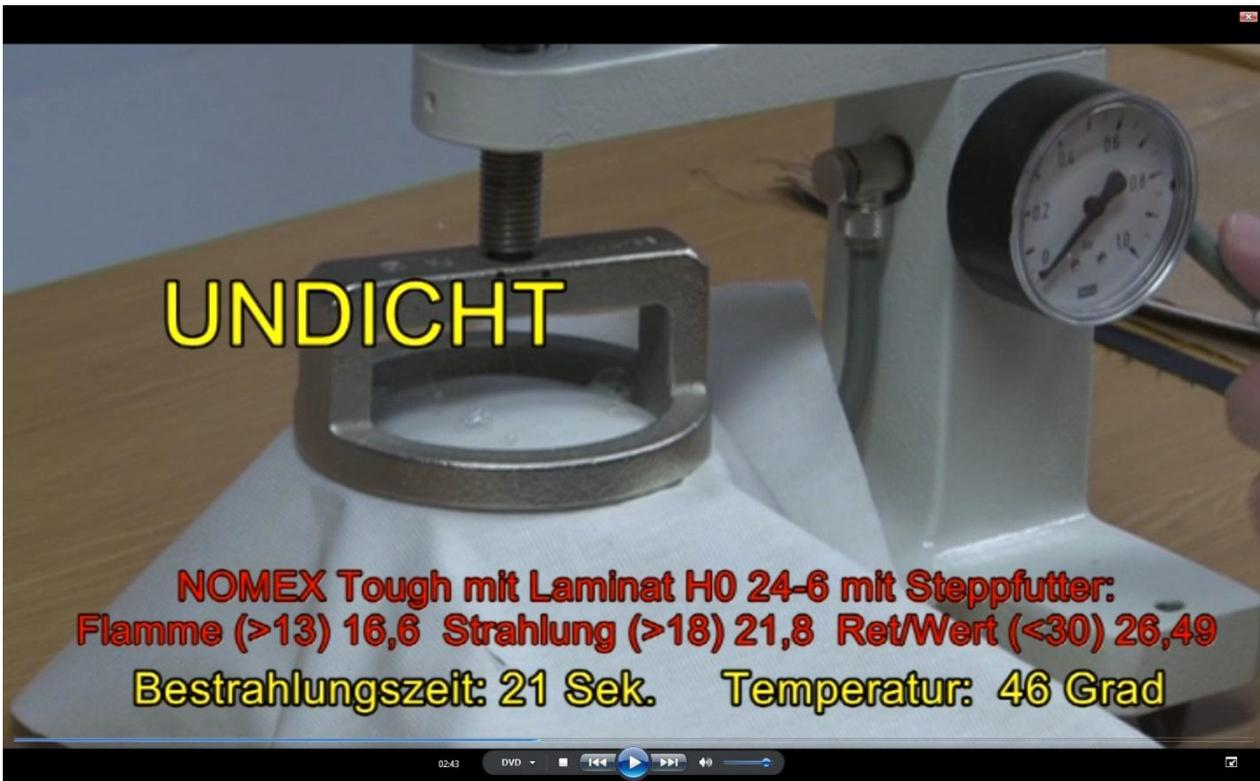
Diese sehr gebräuchliche Schutzkleidung ist bei einer Bestrahlungszeit von 21 Sek. und einer Temperatur von 46° auf der Haut gemessen, **UNDICHT** und für einen weiteren Einsatz als Schutzkleidung nicht mehr zu verwenden!!! Da an der Stoffaußenseite keine Schäden zu erkennen sind, kann ohne es zu wissen, Wasser dort eindringen und die Gefahr des Verbrühens steigt!
