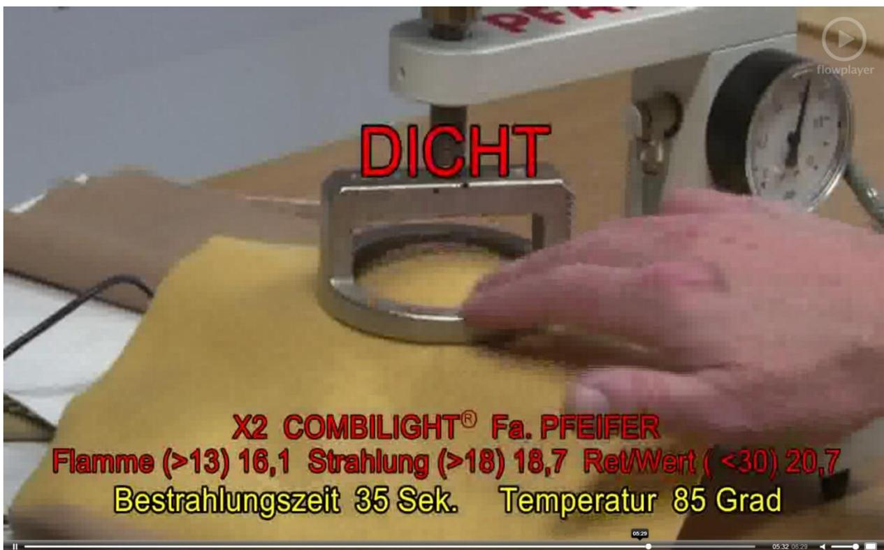
Nach 35 Sek. Bestrahlungszeit und einer Temperatur von 85° auf der Haut ist die Schutzkleidung COMBILIGHT® von Pfeifer **DICHT!!!! Und kann ohne Bedenken für weitere Einsätze als Schutzkleidung verwendet werden!!!!** Da an der Stoffaußenseite keine Schäden zu erkennen sind, ist eine funktionierende Schutzkleidung Vertrauenssache, das wir Ihnen bieten!!!! Qualität von Pfeifer, kombinierbar mit Einsatzanzug KS-03!!!!
